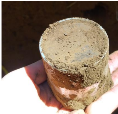
Figura 11: Descripción de calicata y muestreo de densidad aparente de suelo con cilindro de volumen de 100 cm 3 .
