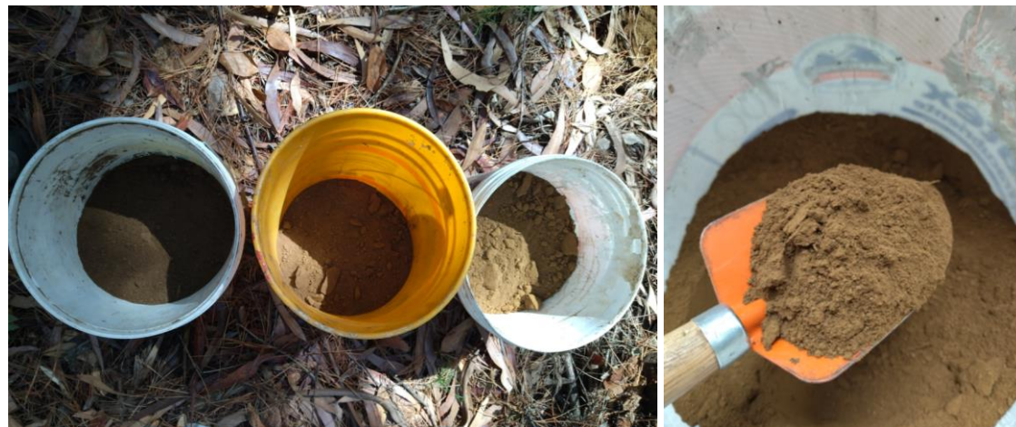
Figura 12: Muestreo de suelo mineral usando barreno y separando por profundidad.
